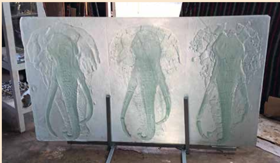
Ein Probeguss der Elefantenmutter mit ihren beiden Kälbern: Dieser wurde aus nicht homogenem Floatglas gefertigt, das eindeutig nicht derselben Charge entstammte – ein Teil ist durch die Zinnschicht aus dem Fertigungsprozess grünlich gefärbt.
